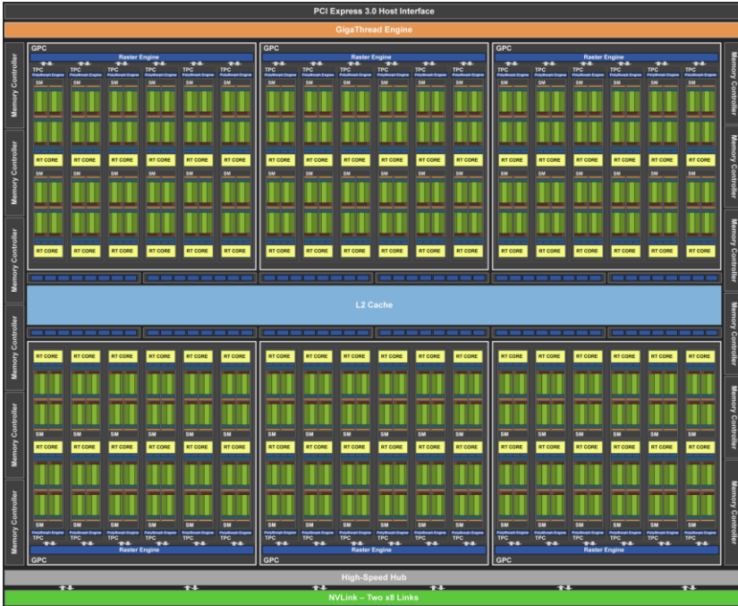
الشكل 13.4.8 معمارية NVIDIA Turing (الصورة مقدمة من NVIDIA)
